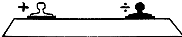
Begge skinner er isoleret fra underlaget, den ene plus, den anden minus. Jævnstrøm. (Fleischmann)
